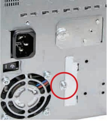
CompactFlash カードの取り付け
