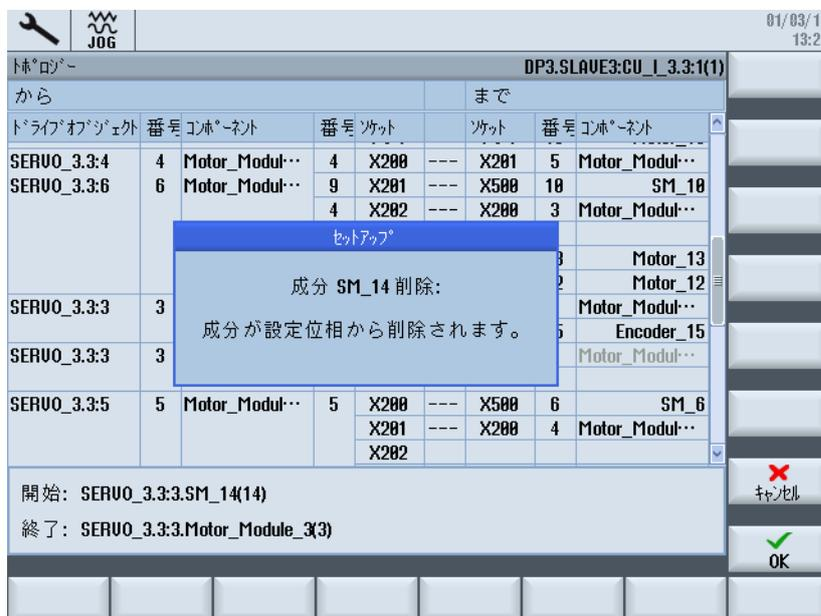
4. 問題なければ、[OK]により確認します。コンポーネントが、基準接続形態から削除されます。
