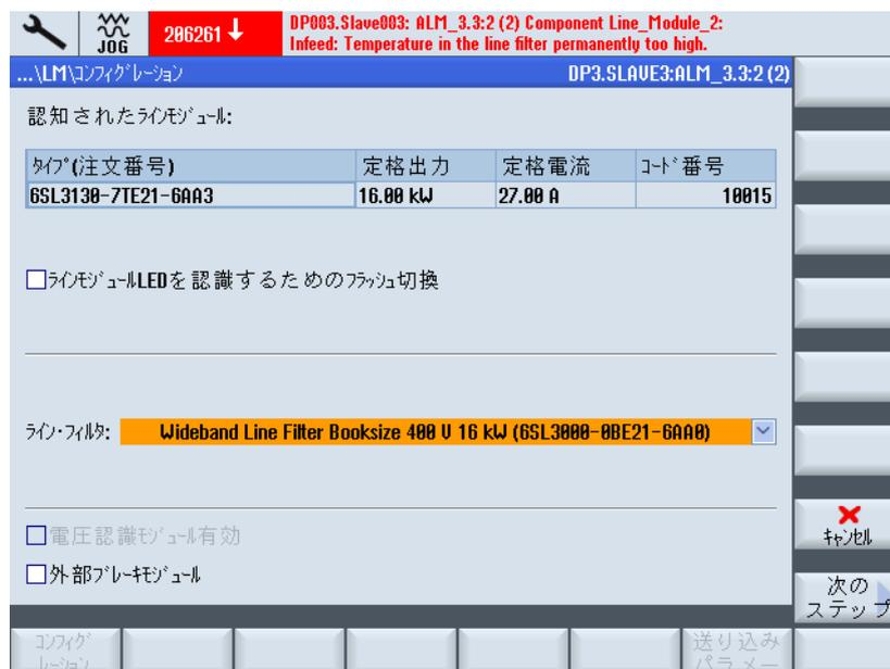
3. ネットフィルタを選択します。この例では、Broadband Line Filter (16 kW)を使用します。
