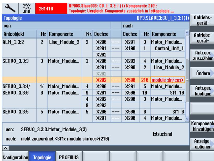
コンポーネントが実際の接続形態でまだ使用可能でない場合(つまり、さらに接続される場合)、アラームが出力され、コンポーネントが赤色で強調表示されます。接続
