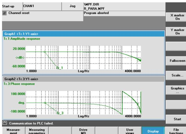
図 8-19 電流コントローラ
