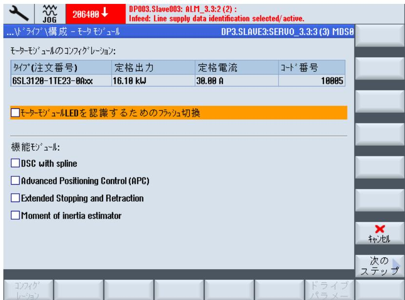
3. モータモジュールタイプが検出されて出力されます。使用可能な機能モジュールを有効にします。
