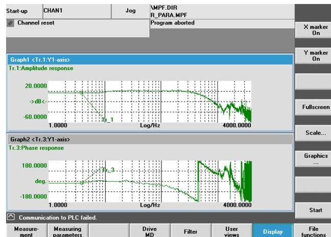
図 8-23 最適化された速度制御ループ
