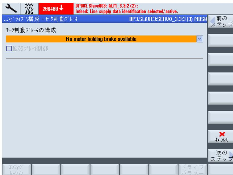
7. [設定 - モータ保持ブレーキ]対話画面で、ブレーキ制御を選択できます。ユニットコンフィグレーション中に、接続されたブレーキが検出されると、ブレーキ制御が自動的に有効化され、初期設定でここに「手順制御によるブレーキ制御」が表示されます。
