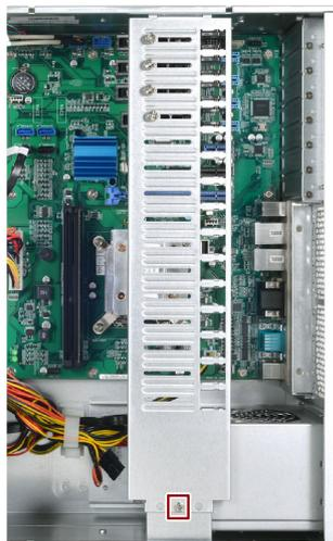
2. 拡張カードのためのスロットのロットブラケットを取り外します。
