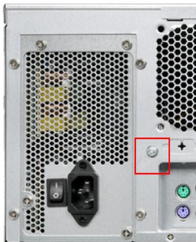
1. 識別された機能接地接続部を、装置が取り付けられている制御キャビネットの保護導体に接続します。
