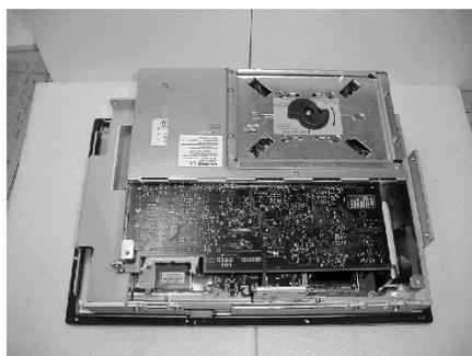
7. スロットカバーのねじ1ヶ所 (M3, トルクスねじ) を外し, スロットカバーを取外します。
