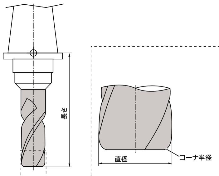
図 11-12 ラジアスエンドミルを例とした 3 次元工具(タイプ 121)
