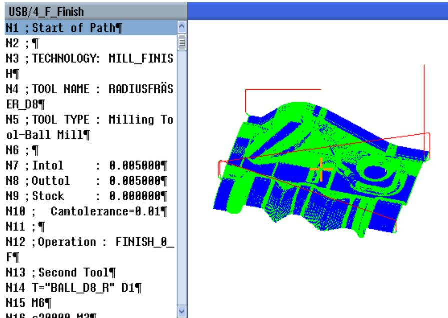
金型加工表示では、左に一覧表示されている NC ブロックと関連する点を行き来できます。
