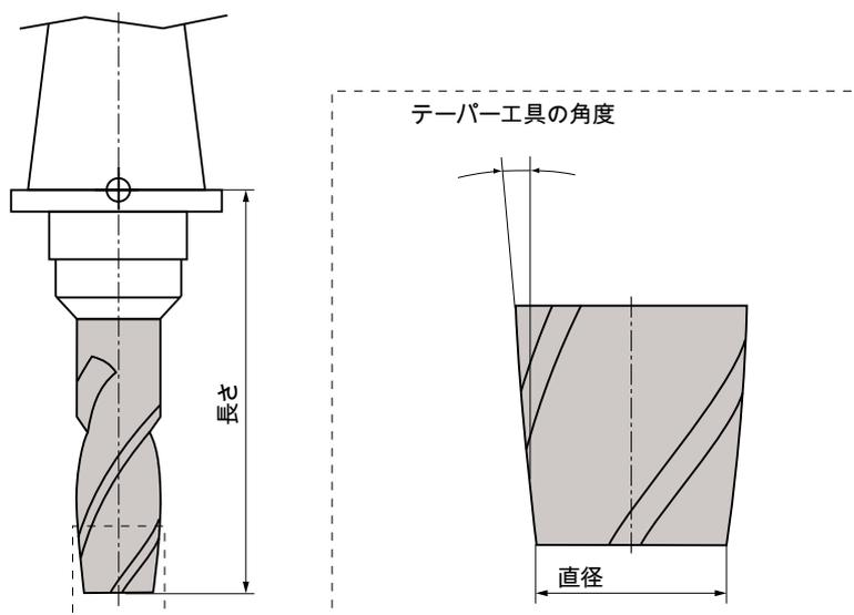
図 11-13 テーパー刃エンドミルを例にした 3 次元工具(タイプ 155)
