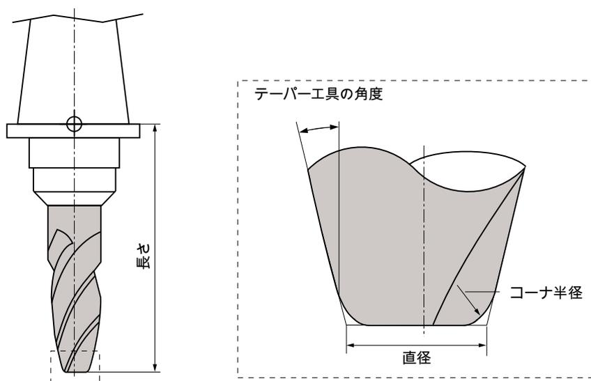
図 11-14 テーパー刃ラジアスエンドミルを例にした 3 次元工具(タイプ 156)
