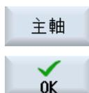
工具を主軸にロードするために[主軸]ソフトキーを押して、[OK]ソフトキーを押します。
