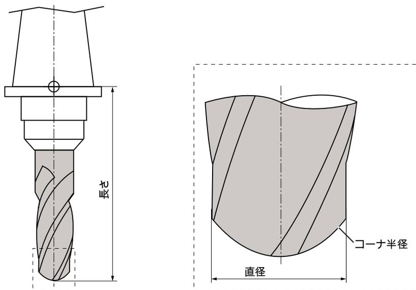
図 11-11 丸底エンドミルを例とした 3 次元工具(タイプ 111)
