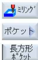
1. [ミリング]ソフトキー、[ポケット]ソフトキー、および[長方形ポケット]ソフトキーを押します。
