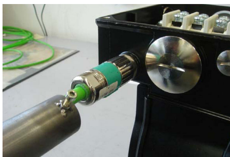
図 6-3 信号コネクタを取り外すには、保護チューブを信号コネクタの上にスライドさせます。
