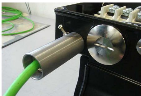
図 6-4 コネクタを取り外すための保護チューブを終端位置にネジ止めします。
