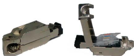
図 9-6 ケーブルアウトレットが 145°の RJ45 PN コネクタ
