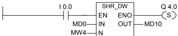
SHR\_DW ボックスは、I0.0 のロジック"1"によってアクティブ化されます。MD0 はロードされ、MW4 に指定されたビット数だけ右にシフトされます。この結果は、MD10 に書き込まれます。Q4.0 は設定されます。
