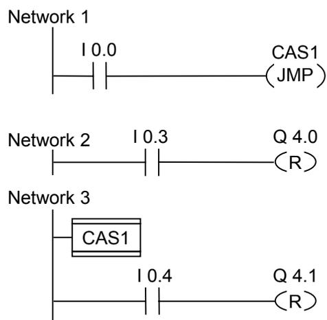
I0.0 が"0"のとき、ラベル CAS1 へのジャンプが実行されます。ジャンプの性質上、I0.3 のロジック状態が"1"の場合でも、出力 Q4.0 をリセットする命令は実行されません。
