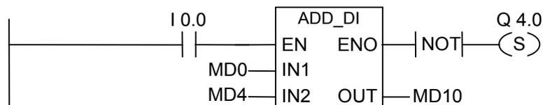
ADD\_DI ボックスは、I0.0の信号状態が"1"になると、アクティブ化されます。加算 MD0 + MD4の結果は、MD10に出力されます。この結果が倍長整数の許容範囲外の場合は、出力 Q4.0が設定されます。
