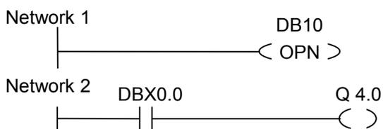
データブロック 10(DB10)が開きます。接点アドレス(DBX0.0)は、DB10 に格納された現行データレコードのデータバイト 0 のビット 0 を参照します。このビットの信号状態は、出力 Q 4.0 に割り付けられます。
