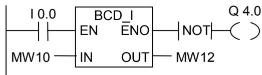
I0.0 が"1"のとき、MW10 の内容が、3 桁の BCD コード番号として読み取られ、整数に変換されます。この結果は、MW12 に格納されます。変換が実行されない場合(ENO = EN = 0)、出力 Q4.0 は"1"になります。
