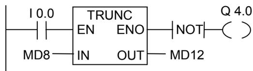
I0.0が"1"のとき、MD8の内容が、実数として読み取られ、倍長整数に変換されます。浮動小数点数の整数部分が結果となり、MD12に格納されます。オーバーフローが発生したか、命令が実行されなかった(I0.0 = 0)場合は、出力 Q4.0 が"1"になります。
