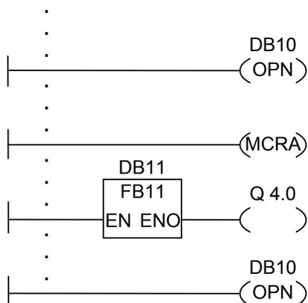
上記のラダー回路は、ユーザーが作成したファンクションブロックのプログラムセクションです。このFBでは、DB10が開き、MCRの機能が有効になります。条件なしでFB11の呼び出しが実行されると、次の状態が発生します。
