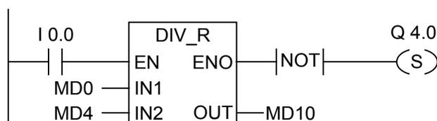
DIV\_R ボックスは、I0.0 のロジック"1"によってアクティブ化されます。除算 MD0÷MD4 の結果は、MD10 に出力されます。この結果が浮動小数点数の許容範囲外の場合、プログラムステートメントが処理されなかった場合は、出力 Q4.0 が設定されます。
