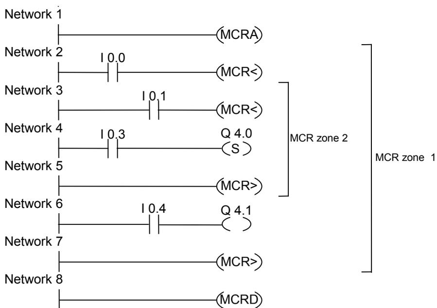
MCRの機能は、MCRA回路によって有効になります。これにより、最大で8段階にネストされたMCRゾーンを作成できます。この例では、2つのMCRゾーンがあり、次のようにファンクションが実行されます。
