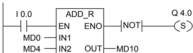
ADD\_R ボックスは、I0.0 のロジック"1"によってアクティブ化されます。加算 MW0+MW4 の結果は、MW10 に出力されます。この結果が浮動小数点数の許容範囲外の場合、プログラムステートメントが処理されなかった場合は(I0.0 = 0)、出力 Q4.0 が設定されます。
