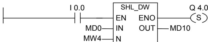
SHL\_DW ボックスは、I0.0 のロジック"1"によってアクティブ化されます。MD0 はロードされ、MW4 に指定されたビット数だけ左にシフトされます。この結果は、MD10 に書き込まれます。Q4.0 は設定されます。
