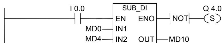
SUB\_DI ボックスは、I0.0 の信号状態が"1"になると、アクティブ化されます。減算 MD0 - MD4 の結果は、MD10 に出力されます。この結果が倍長整数の許容範囲外の場合は、出力 Q4.0 が設定されます。
