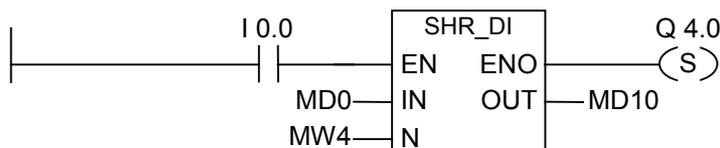
SHR\_DI ボックスは、I0.0 のロジック"1"によってアクティブ化されます。MD0 はロードされ、MW4 に指定されたビット数だけ右にシフトされます。この結果は、MD10 に書き込まれます。Q4.0 は設定されます。
