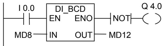
I0.0 が"1"のとき、MD8 の内容が、倍長整数として読み取られ、7 桁の BCD 番号に変換されます。この結果は、MD12 に格納されます。オーバーフローが発生したか、命令が実行されなかった(I0.0=0)場合は、出力 Q4.0 が"1"になります。
