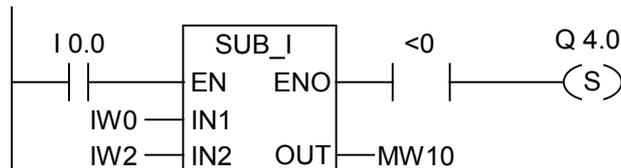
ボックスは、I0.0 の信号状態"1"によってアクティブ化されます。IW0 の値が IW2 の値より小さい場合、演算ファンクション IW0-IW2 の結果は"0"より小さくなります。ファンクションが正しく実行され、結果が"0"より小さい場合、Q4.0 が設定されます。
