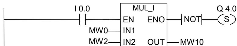
MUL\_I ボックスは、I0.0 の信号状態が"1"になると、アクティブ化されます。乗算 MW0 x MW2 の結果は、MW10 に出力されます。この結果が整数の許容範囲外の場合は、出力 Q4.0 が設定されます。
