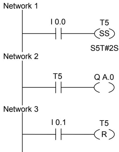
入力 I0.0 の信号状態が"0"から"1"になると(RLO が信号立ち上がり)、タイマ T5 が起動します。タイマが終了する前に入力 I0.0 の信号状態が"0"から"1"になると、タイマは再トリガされます。タイマが終了すると、出力 Q4.0 は"1"になります。入力 I0.1 の信号状態が"1"になると、タイマ T5 はリセットされて停止し、残り時間は"0"にクリアされます。
