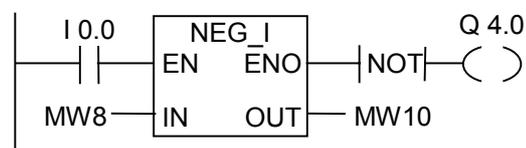
I0.0が"1"の場合、MW8の値に逆の記号が付き、パラメータ OUTにより MW10に出力されます。
