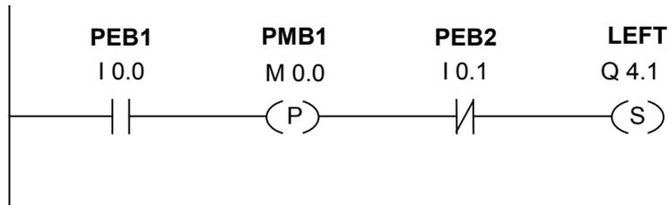
ネットワーク 2: 入力 I 0.1 の信号状態が 0 から 1(信号立ち上がり)に移行すると同時に、入力 I 0.0 の信号状態が 0 になっている場合は、ベルト上の荷物が右に移動しています。物体が光電バリアの一方を通過するという事は、2 個の光電バリアの間に物体があるということです。
