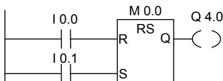
入力 I0.0 の信号状態が"1"、I0.1 の信号状態が"0"の場合、メモリビット M0.0 は設定され、出力 Q4.0 は"0"になります。そうではなく、入力 I0.0 の信号状態が"0"、I0.1 の信号状態が"1"の場合、メモリビット M0.0 はリセットされ、出力 Q4.0 は"1"になります。両方の信号状態が"0"の場合、何も起こりません。両方の信号が"1"の場合は、順序に従ってセット命令が実行されるため、M0.0 が設定され、Q4.0 が"1"になります。
