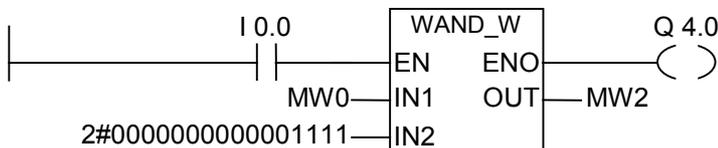
命令は、I0.0 が"1"のときに実行されます。MW0 のビット 0~3 のみが対象となり、残りのビットは、IN2 ワードビットパターンによりマスクされます。
