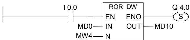
ROR\_DW ボックスは、I0.0 のロジック"1"によってアクティブ化されます。MD0 はロードされ、MW4 に指定されたビット数だけ右に循環します。この結果は、MD10 に書き込まれます。Q4.0 は設定されます。
