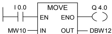
入力 I0.0 が 1 になると、命令が実行され、MW10 の内容が現在のオープン DB のデータワード 12(DBW12)にコピーされます。
