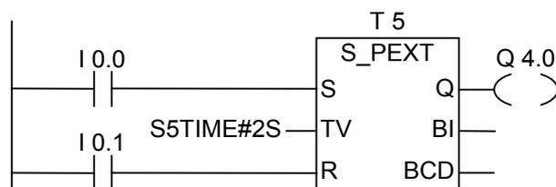
入力 I0.0 の信号状態が"0"から"1"(RLO の信号立ち上がり)になると、タイマ T5 が起動します。このタイマは、入力 S の信号立ち下がりにも影響されず、2 秒(2s)の指定時間だけ実行を続けます。タイマが終了する前に I0.0 の信号状態が"0"から"1"になると、タイマは再トリガされます。タイマの実行中、出力 Q4.0 はロジック"1"になります。
