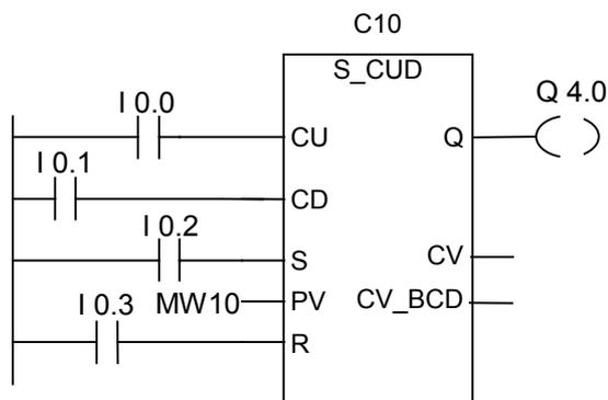
I0.2が"0"から"1"に変わると、MW10の値でカウンタが事前設定されます。I0.0の信号状態が"0"から"1"に変わると、カウンタ C10の値が1増えます。ただし、C10の値が"999"に等しい場合は例外です。I0.1が"0"から"1"に変わると、C10は1減ります。ただし、C10の値が"0"に等しい場合は例外です。C10が0でない場合、Q4.0は"1"になります。
