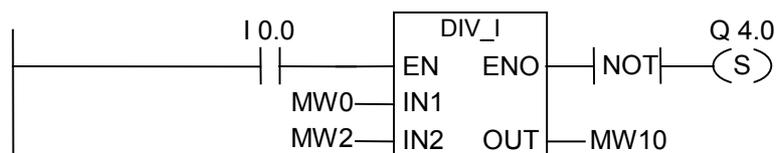
**DIV\_I** ボックスは、I0.0 の信号状態が"1"になると、アクティブ化されます。除算  $MW0 \div MW2$  の結果は、MW10 に出力されます。この結果が整数の許容範囲外の場合は、出力 Q4.0 が設定されます。
