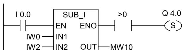
ボックスは、I0.0 の信号状態"1"によってアクティブ化されます。IW0 の値が IW2 の値より大きい場合、演算ファンクション IW0-IW2 の結果は"0"より大きくなります。ファンクションが正しく実行され、結果が"0"より大きい場合、Q4.0 が設定されます。
