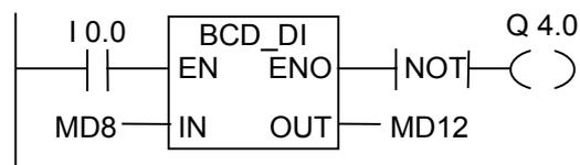
I0.0 が"1"のとき、MD8 の内容が、7 桁の BCD コード番号として読み取られ、倍長整数に変換されます。この結果は、MD12 に格納されます。変換が実行されない場合(ENO = EN = 0)、出力 Q4.0 は"1"になります。
