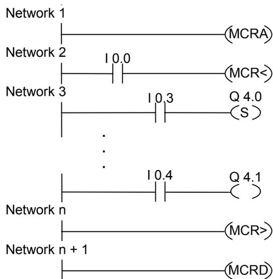
MCR の機能は、MCRA 回路によって有効になります。MCR<と MCR>間の回路(出力 Q4.0、Q4.1)は、次のように実行されます。
