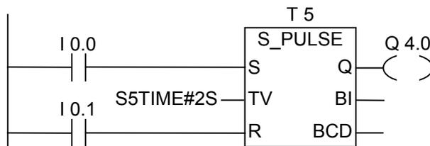
入力 I0.0 の信号状態が"0"から"1"(RLO の信号立ち上がり)になると、タイマ T5 が起動します。入力 I0.0 が"1"である場合、タイマは指定された 2 秒間実行を継続します。時間が経過する前に、入力 I0.0 の信号状態が"1"から"0"に遷移した場合、タイマは停止されます。タイマの実行中に入力 I0.1 の信号状態が"0"から"1"に変わると、タイマはリセットされます。
