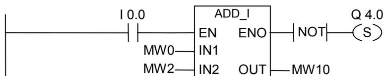
ADD\_I ボックスは、I0.0 の信号状態が"1"になると、アクティブ化されます。加算 MW0 + MW2 の結果は、MW10 に出力されます。この結果が整数の許容範囲外の場合は、出力 Q4.0 が設定されます。
