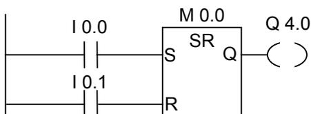
入力 I 0.0 の信号状態が"1"、I 0.1 の信号状態が"0"の場合、メモリビット M 0.0 は設定され、出力 Q 4.0 は"1"になります。そうではなく、入力 I 0.0 の信号状態が"0"、I 0.1 の信号状態が"1"の場合、メモリビット M 0.0 はリセットされ、出力 Q 4.0 は"0"になります。両方の信号状態が"0"の場合、何も起こりません。両方の信号が"1"の場合は、順序に従ってリセット命令が実行されるため、M 0.0 がリセットされ、Q 4.0 が"0"になります。
