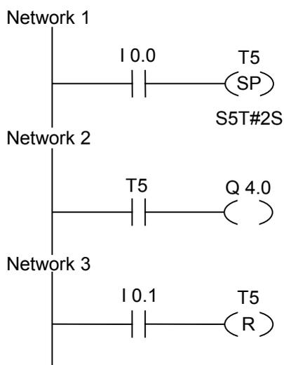
入力 I0.0 の信号状態が"0"から"1"になると(RLO が信号立ち上がり)、タイマ T5 が起動します。入力 I0.0 の信号状態が"1"である場合、タイマは指定された時間(2 秒間)実行を継続します。指定した時間が経過する前に、入力 I0.0 の信号状態が"1"から"0"に遷移した場合、タイマは停止されます。
