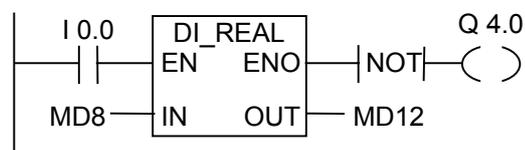
I0.0 が"1"のとき、MD8 の内容が、倍長整数として読み取られ、浮動小数点数に変換されます。この結果は、MD12 に格納されます。変換が実行されない場合(ENO = EN = 0)、出力 Q4.0 は"1"になります。
