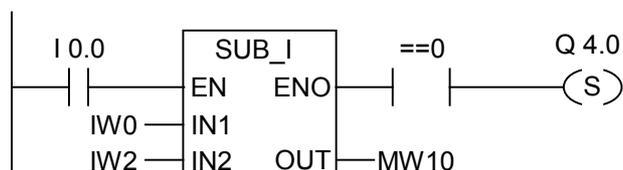
ボックスは、I0.0 の信号状態"1"によってアクティブ化されます。IW0 の値が IW2 の値と等しい場合、演算ファンクション IW0-IW2 の結果は"0"になります。ファンクションが正しく実行され、結果が"0"と等しい場合、Q4.0 が設定されます。
