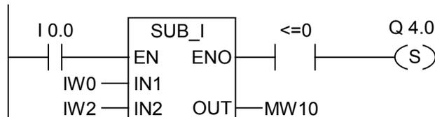
ボックスは、I0.0 の信号状態"1"によってアクティブ化されます。IW0 の値が IW2 の値以下の場合、演算ファンクション IW0-IW2 の結果は"0"以下になります。ファンクションが正しく実行され、結果が"0"以下の場合、Q4.0 が設定されます。
