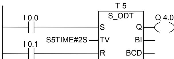
入力 I0.0 の信号状態が"0"から"1"(RLO の信号立ち上がり)に変わると、タイマ T5 が起動します。2 秒が経過しても、入力 I0.0 の信号状態が"1"のままであれば、出力 Q4.0 の信号状態は"1"になります。入力 I0.0 の信号状態が"1"から"0"に遷移した場合、タイマは停止し、出力 Q4.0 は"0"になります。タイマの実行中に入力 I0.1 の信号状態が"0"から"1"に遷移した場合、タイマはリセットされます。
