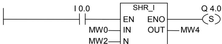
SHR\_I ボックスは、I0.0 のロジック"1"によってアクティブ化されます。MW0 はロードされ、MW2 に指定されたビット数だけ右にシフトされます。この結果は、MW4 に書き込まれます。Q4.0 は設定されます。
