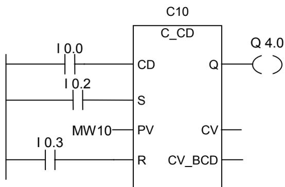
I0.2が"0"から"1"に変わると、MW10の値でカウンタが事前設定されます。I0.0の信号状態が0から1に変わると、カウンタ C10 の値が1ずつ減ります。ただし、C10の値が"0"のときは例外です。C10が0でない場合、Q4.0は"1"になります。
