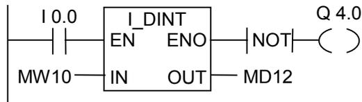
I 0.0 が"1"の場合、MW10 の内容が、整数値として読み取られ、倍長整数に変換されます。この結果は、MD12 に格納されます。変換が実行されない場合(ENO = EN = 0)、出力 Q4.0 は"1"になります。
