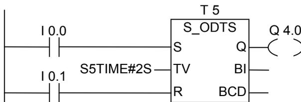
入力 I0.0 の信号状態が"0"から"1"(RLO の信号立ち上がり)に変わると、タイマ T5 が起動します。入力 I0.0 の信号状態が"1"から"0"に遷移するかどうかにかかわらず、タイマは実行されます。タイマが期限切れになる前に入力 I0.0 の信号状態が"0"から"1"に遷移した場合、タイマは再起動されます。タイマが終了すると、出力 Q4.0 は"1"になります。(入力 I0.1 の信号状態が"0"から"1"になると、S の RLO に関係なくタイマはリセットされる)。
