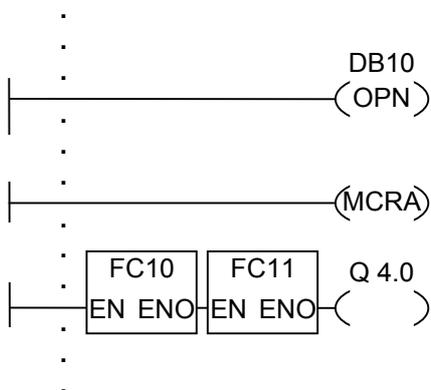
上記のラダー回路は、ユーザーが作成したファンクションブロックのプログラムセクションです。このFBでは、DB10が開き、MCRの機能が有効になります。FC10の条件なしの呼び出しが実行されると、次の状態が発生します。
