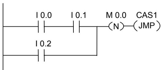
信号メモリビット M0.0 は、RLO の前の状態を保存します。RLO の信号状態が"1"から"0"に変わると、プログラムはラベル CAS1 へジャンプします。
