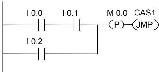
信号メモリビット M0.0 は、RLO の前の状態を保存します。RLO の信号状態が"0"から"1"に変わると、プログラムはラベル CAS1 へジャンプします。
