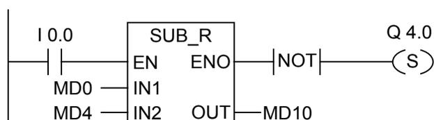
SUB\_R ボックスは、I0.0 のロジック "1" によってアクティブ化されます。減算 MD0 - MD4 の結果は、MD10 に出力されます。この結果が浮動小数点数の許容範囲外の場合か、プログラムステートメントが処理されなかった場合は、出力 Q4.0 が設定されます。
