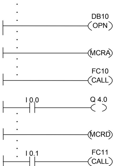
上記のラダー回路は、ユーザーが作成したファンクションブロックのプログラムセクションです。このFBでは、DB10が開き、MCRの機能が有効になります。FC10の条件なしの呼び出しが実行されると、次の状態が発生します。
