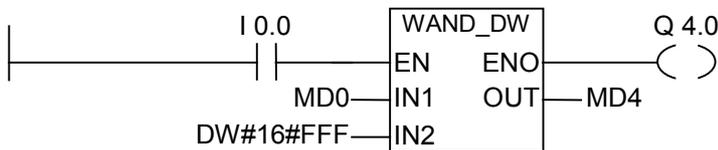
命令は、I0.0 が"1"のときに実行されます。MD0 のビット 0~11 のみが対象となり、残りのビットは、IN2 ビットパターンによりマスクされます。
