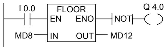
I0.0 が"1"の場合、MD8 の内容が浮動小数点数として読み取られ、"丸め-無限大"モードにより倍長整数に変換されます。この結果は、MD12 に格納されます。オーバーフローが発生したか、命令が実行されなかった(I0.0 = 0)場合は、出力 Q4.0 が"1"になります。
