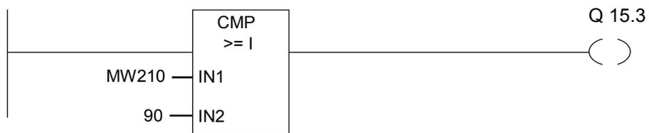
ネットワーク 5: カウンタ値が 100 以上の場合は、“格納エリア満杯”を示す表示ランプが点灯します。
