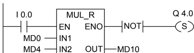
MUL\_R ボックスは、I0.0 のロジック"1"によってアクティブ化されます。乗算 MD0 x MD4 の結果は、MD0 に出力されます。この結果が浮動小数点数の許容範囲外の場合か、プログラムステートメントが処理されなかった場合は、出力 Q4.0 が設定されます。
