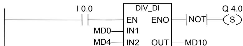
DIV\_DI ボックスは、I0.0 の信号状態が"1"になると、アクティブ化されます。除算 MD0 ÷ MD4 の結果は、MD10 に出力されます。この結果が倍長整数の許容範囲外の場合は、出力 Q4.0 が設定されます。
