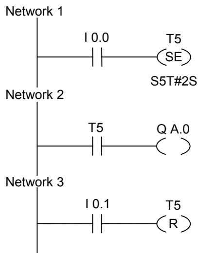
入力 I0.0 の信号状態が"0"から"1"になると(RLO が信号立ち上がり)、タイマ T5 が起動します。RLO が信号立ち下がりであっても、タイマは実行し続けます。タイマが終了する前に、I0.0 の信号状態が"0"から"1"に変わると、タイマは再トリガされます。
