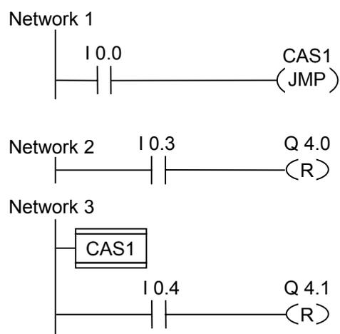
I0.0 が"1"のとき、ラベル CAS1 へのジャンプが実行されます。ジャンプの性質上、I0.3 のロジック状態が"1"の場合でも、出力 Q4.0 をリセットする命令は実行されません。
