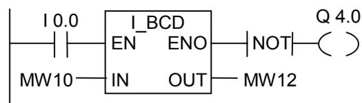
I0.0 が"1"のとき、MW10 の内容が、整数として読み取られ、3 桁の BCD コード番号に変換されます。この結果は、MW12 に格納されます。オーバーフローが発生したか、命令が実行されなかった (I0.0 = 0)場合は、出力 Q4.0 が"1"になります。
