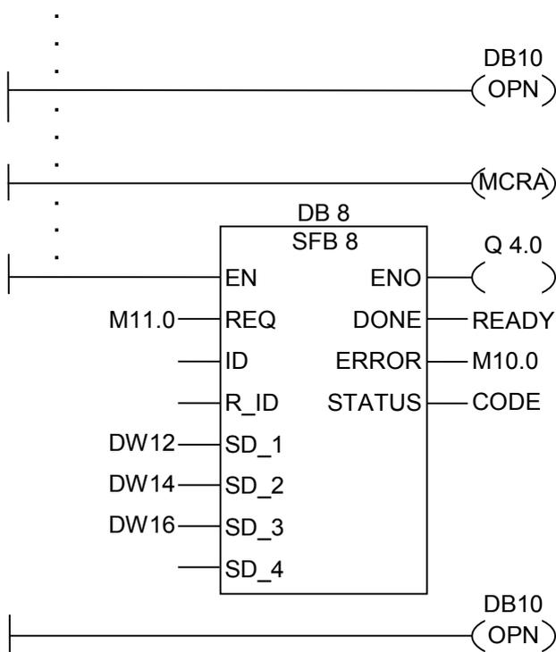
上記のラダー回路は、ユーザーが作成したファンクションブロックのプログラムセクションです。このFBでは、DB10が開き、MCRの機能が有効になります。SFB8の条件なしの呼び出しが実行されると、次の状態が発生します。
