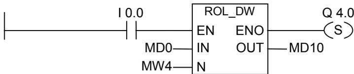
ROL\_DW ボックスは、I0.0 のロジック"1"によってアクティブ化されます。MD0 はロードされ、MW4 に指定されたビット数だけ左に循環します。この結果は、MD10 に書き込まれます。Q4.0 は設定されます。
