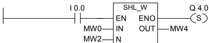
SHL\_W ボックスは、I0.0 のロジック"1"によってアクティブ化されます。MW0 はロードされ、MW2 に指定されたビット数だけ左にシフトされます。この結果は、MW4 に書き込まれます。Q4.0 は設定されます。
