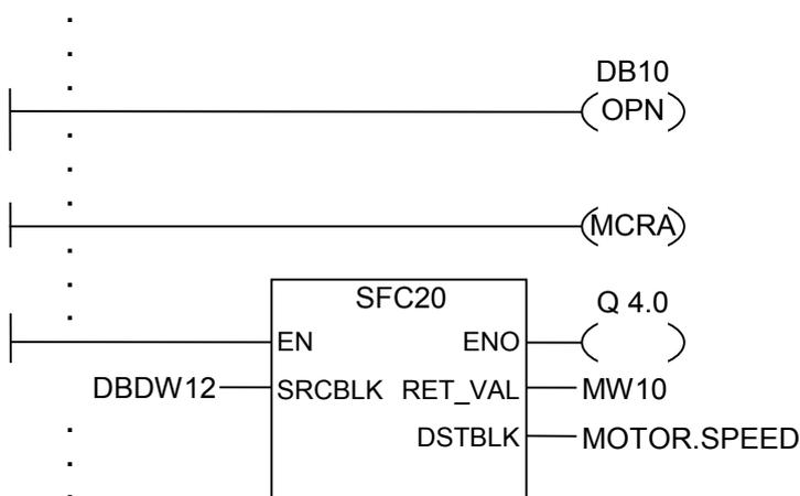
上記のラダー回路は、ユーザーが作成したファンクションブロックのプログラムセクションです。このFBでは、DB10が開き、MCRの機能が有効になります。SFC20の条件なしの呼び出しが実行されると、次の状態が発生します。
