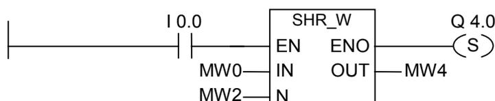
SHR\_W ボックスは、I0.0 のロジック"1"によってアクティブ化されます。MW0 はロードされ、MW2 に指定されたビット数だけ右にシフトされます。この結果は、MW4 に書き込まれます。Q4.0 は設定されます。
