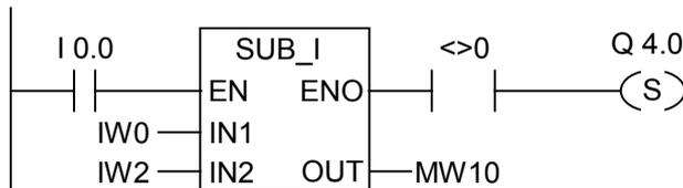
ボックスは、I0.0 の信号状態"1"によってアクティブ化されます。IW0 の値が IW2 の値と異なる場合、演算ファンクション IW0-IW2 の結果は"0"ではない値になります。ファンクションが正しく実行され、結果が"0"と等しくない場合、Q4.0 が設定されます。
