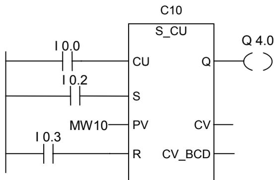
I0.2が"0"から"1"に変わると、MW10の値でカウンタが事前設定されます。I0.0の信号状態が0から1に変わると、カウンタ C10の値が1ずつ増えます。ただし、C10の値が"999"のときは例外です。C10が0でない場合、Q4.0は"1"になります。
