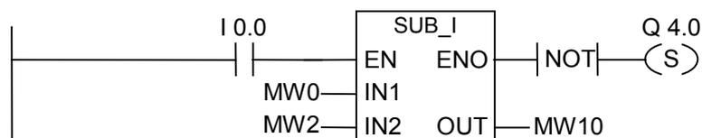
SUB\_I ボックスは、I0.0 の信号状態が"1"になると、アクティブ化されます。減算 MW0 - MW2 の結果は、MW10 に出力されます。この結果が整数の許容範囲外の場合、I0.0 の信号状態が 0 の場合は、出力 Q4.0 が設定されません。
