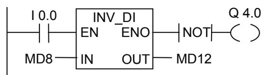
I0.0が"1"の場合、MW8のすべてのビットが逆転します。次にその例を示します。
