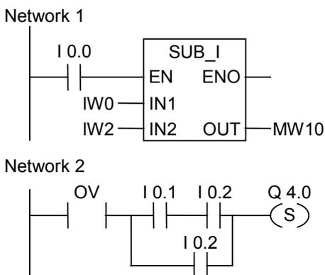
ボックスは、I0.0の信号状態"1"によってアクティブ化されます。数値演算"IW0-IW2"の結果が整数の許容範囲外の場合は、OVビットが設定されます。
