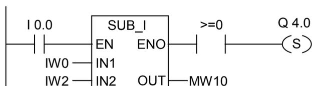
ボックスは、I0.0 の信号状態"1"によってアクティブ化されます。IW0 の値が IW2 の値以上の場合、演算ファンクション IW0-IW2 の結果は"0"以上になります。ファンクションが正しく実行され、結果が"0"以上の場合、Q4.0 が設定されます。
