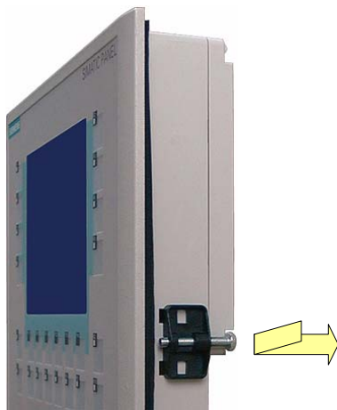
図 4-2 OP 170Bへのスプリング端子の挿入
