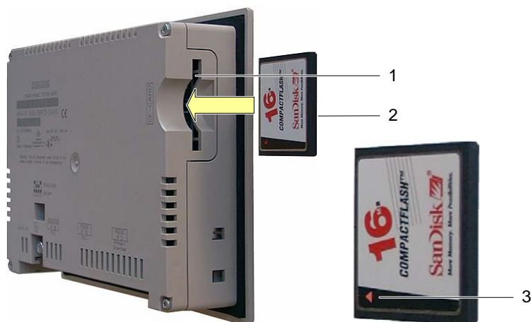
図 5-2 TP 170Bへのメモリカードの差し込み
