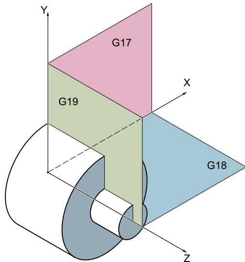
旋盤では通常、Z 軸と X 軸のみを使用します。つまり次のようにになります。
