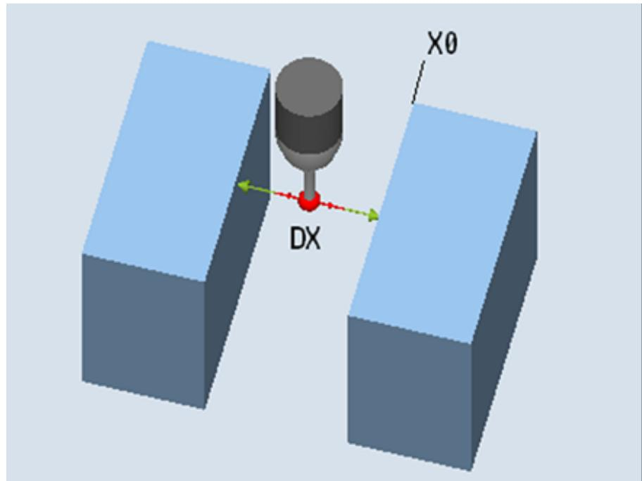
図 3-9 校正:2 つの端面間の半径(CYCLE976)
