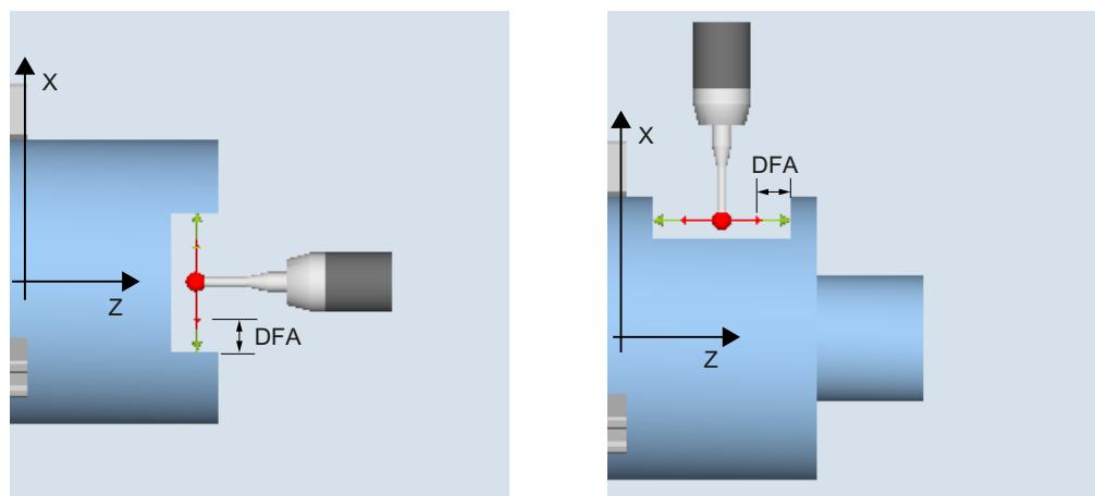
校正:溝でのプローブ(CYCLE973),
