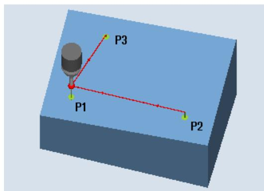
図 3-17 計測:平面の割り出し(CYCLE998)
