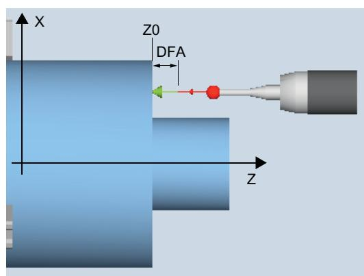
図 3-1 校正:面での長さ(CYCLE973)、例: G18、 $SL=7$
