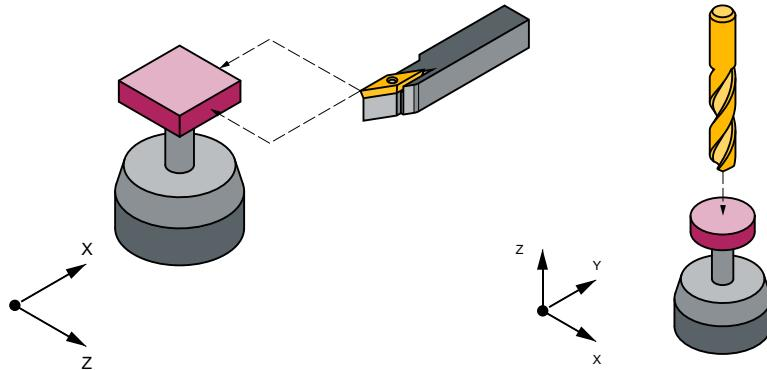
工具計測 - 旋盤工具の例
