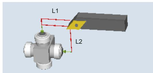
図 3-23 計測: 旋盤工具(CYCLE982)、例:すべて計測
