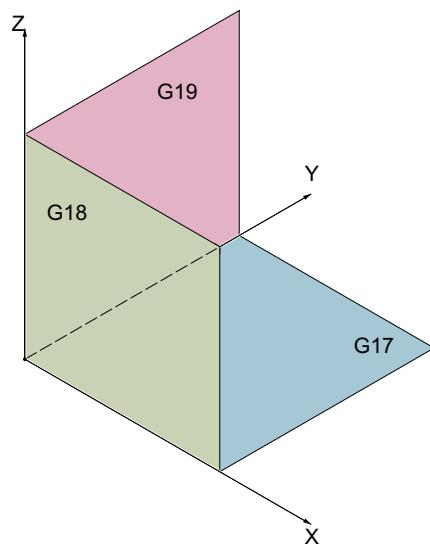
以下のように、工具タイプに応じて工具長が軸に割り当てられます。
