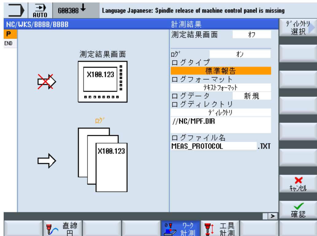
図 2-13 選択ダイアログでログを格納するレベルを入力します。
