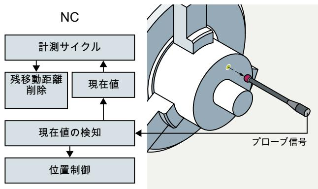
プローブのパルスにトリガされて、軸モーション中に軸の実際の位置が計測され、CNC に保存されます。プローブ信号が検出されると、軸は定義された方法で減速され、計測ブロックの残移動距離が検出され、サイクル内の次の NC ブロックに変更されます。プログラムシーケンスは続行されます。
