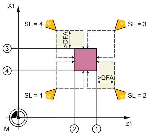
両方の軸の刃先位置 1~4 および適切なアプローチ位置(機械基準)
