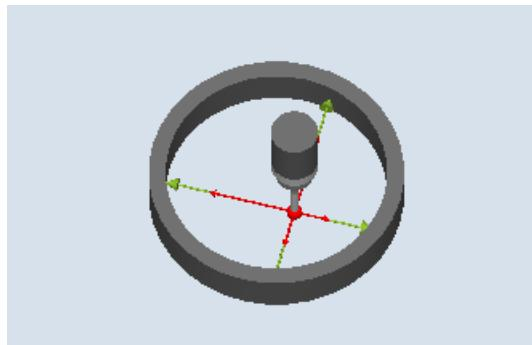
図 3-8 校正:リングでの半径(CYCLE976)
