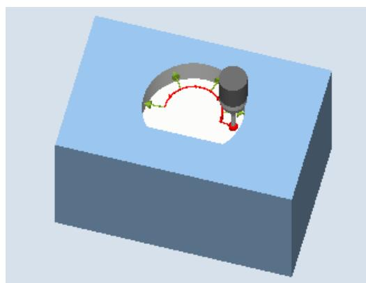
図 3-15 計測:内側の円弧(CYCLE979)、例: 4 つの計測点
