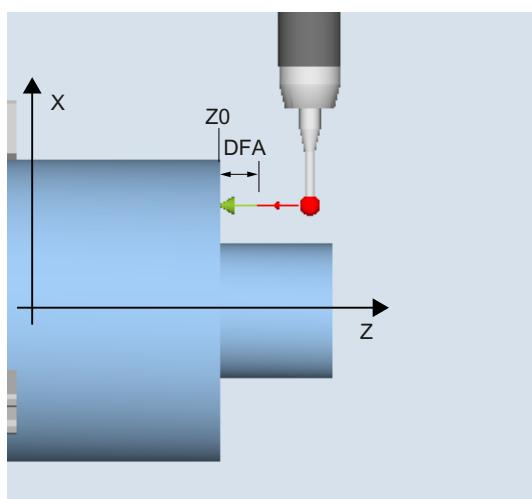
図 3-2 校正:面での半径(CYCLE973)、例: G18、 $SL=8$
