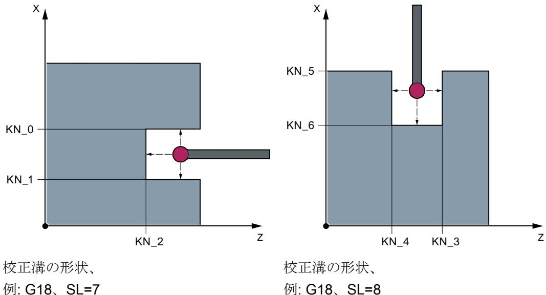
表 3-4 校正溝の寸法の一般セッティングデータ
