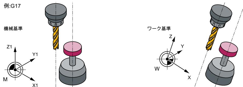
図 3-35 工具軸、プローブ軸および座標系の軸の平行の割り出し
