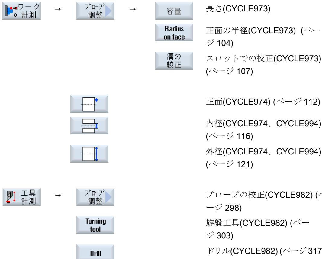
以下のソフトキーは、"フライス盤"拡張機能が設定されている場合(チャネル別の MD52201 \$MCS TECHNOLOGY\_EXTENSION = 2)だけ表示されます。
