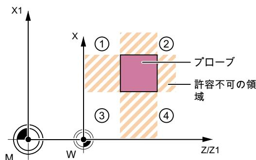
図 3-26 フライス工具の計測:平面の 2 番目の軸(G18 の場合:X)での開始可能位置
