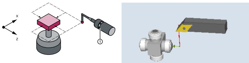
校正工具を使った工具のプローブの校正 旋盤工具を使った工具のプローブの校正
