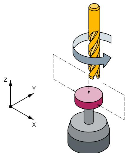
図 2-5 フライス工具の計測
