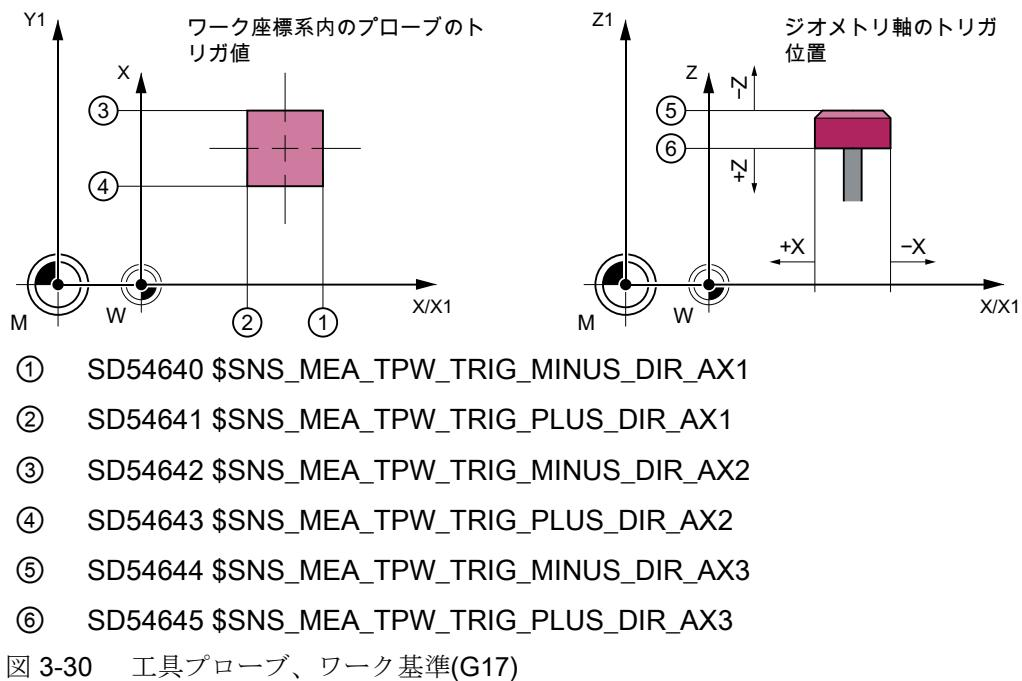
図 3-30 工具プローブ、ワーク基準(G17)
