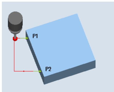
計測:端面の割り出し(CYCLE998)、
