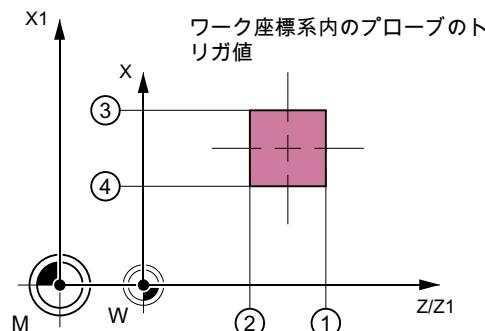
図 3-19 工具プローブ、ワーク基準(G18)
