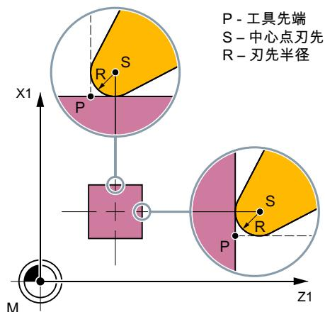
図 3-25 旋盤工具の長さの計測: 刀先半径でのオフセット、**SL=3** の例
