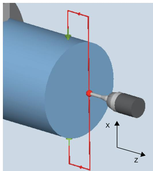
計測:直径、回転中心の上側／下側での外径
