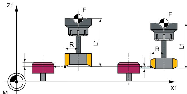
図 3-38 オフセットあり/なしの半径計測
