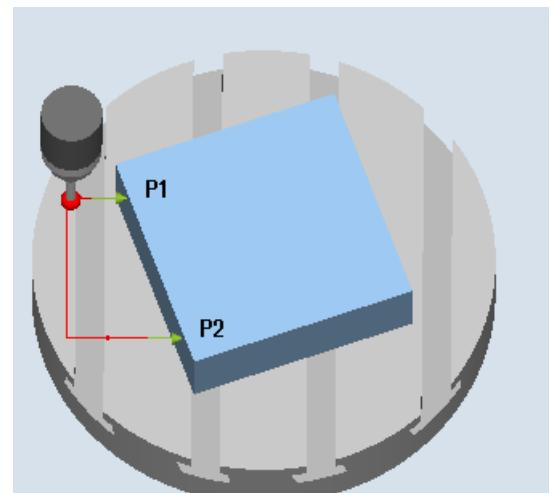
計測:端面の割り出し(CYCLE998)、
