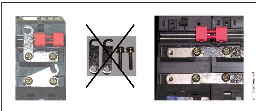
図 2-1 DC リンクブリッジの取り外し
