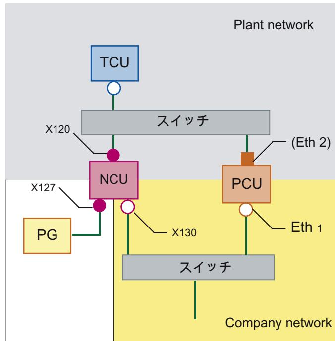
サービス目的のために、プログラミング装置が標準 DHCP クライアントとして X127 で NCU に接続されています(IP アドレスを自動的に取得)。NCU は X127 では標準 DHCP サーバです。NCU は、X127 では固定 IP アドレス 192.168.215.1、サブネットマスク 255.255.255.224 を占有します。
