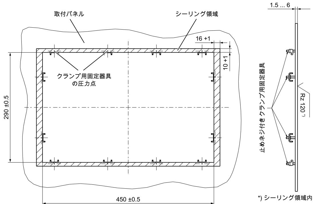
図 5-1 OP 010 操作パネル取り付けの寸法図
