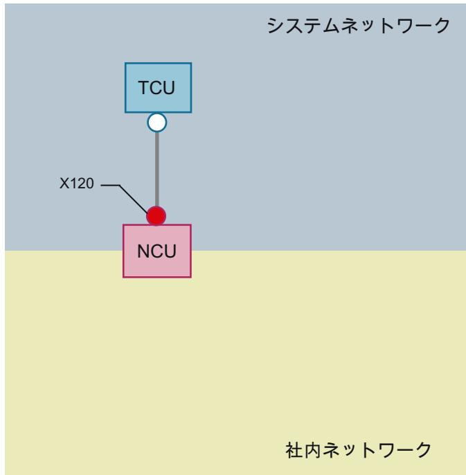
TCU を NCU の X120 に接続するには、ダイレクト Ethernet 接続が使用されます。NCU と TCU には IP アドレスが適切に事前設定されています。
