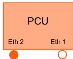
Eth 1 は、社内ネットワークへの接続用の既定の DHCP クライアントとして事前選択されています。
