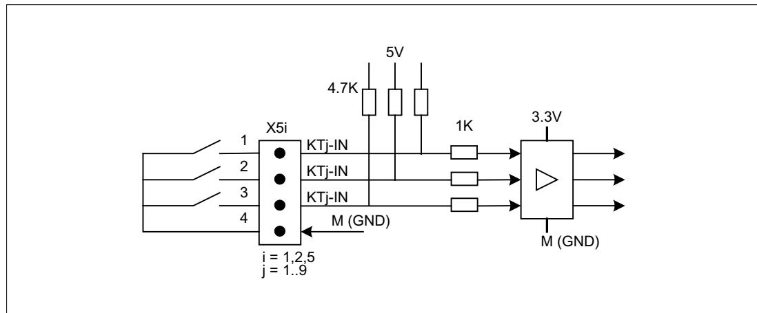
図 1-5 X51、X52、X55 の入力回路の回路図
