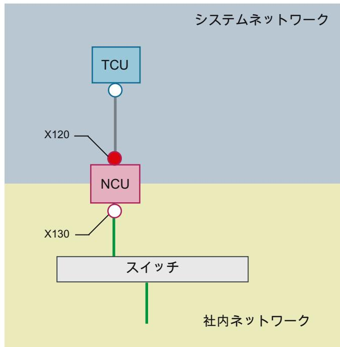
TCU はクロス Ethernet ケーブルを使用して NCU に(直接)接続されています。NCU は、X130 を介してストレートケーブルで社内ネットワークへのスイッチに接続されています。
