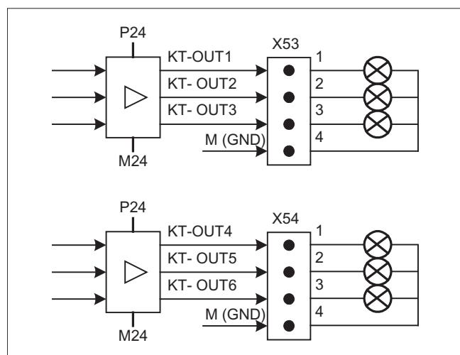
図 1-6 X53 および X54 の入力回路の主回路図
