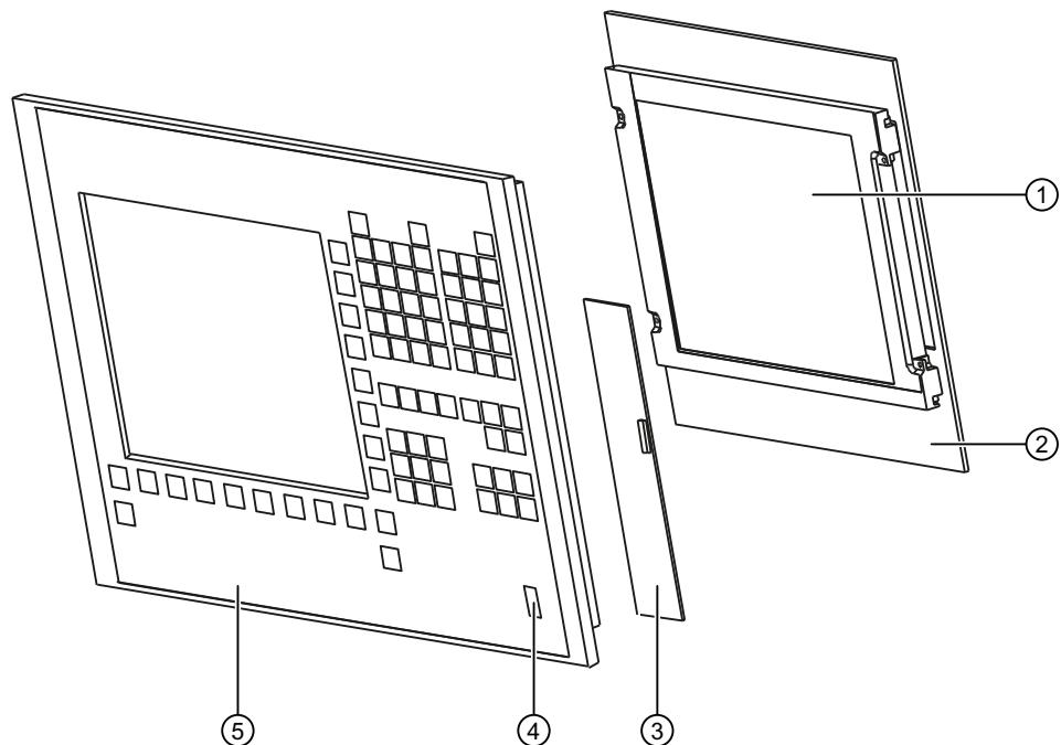
図 7-1 OP 010 操作パネルの個々の部品
