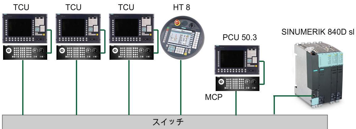
可搬式の SINUMERIK HT 8 ハンドヘルドターミナルは、シンクライアント原則に基づいて動作し、操作パネルと機械操作パネルの機能を併せ持っています。
