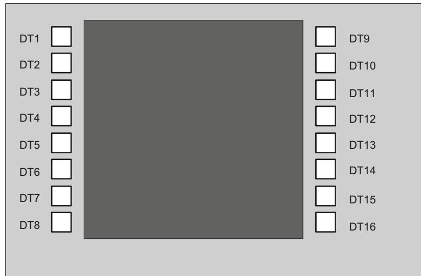
図 1-7 操作パネルの垂直ソフトキーへのダイレクトキーの割り当て
