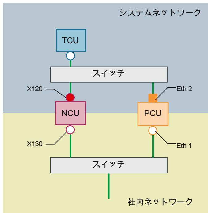
この構成では、システムネットワークにもスイッチが必要です。すべてのコンポーネントはストレート Ethernet ケーブルを使用して接続されます。
