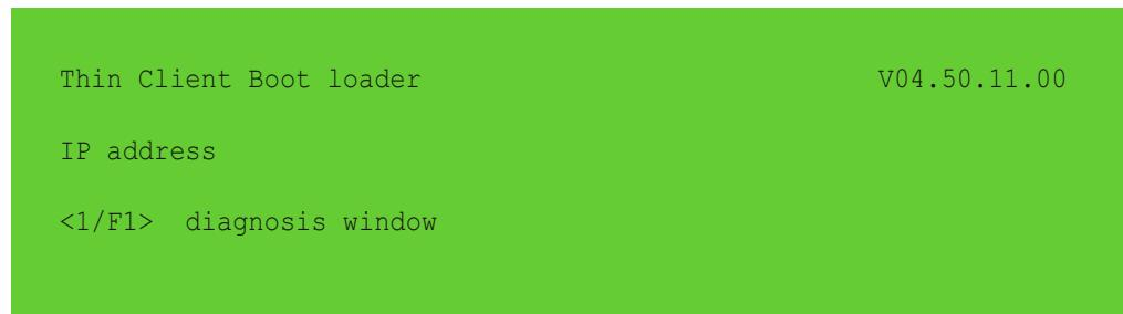
現在の起動状態は3行目に示されます。障害が発生した場合は、その下に、**<F1>**を押すと情報を呼び出せることが通知されます。
