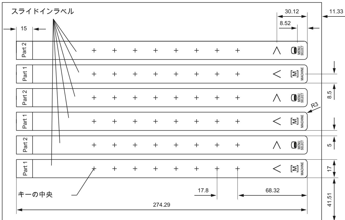
図 7-2 スライドインラベルの外形寸法
