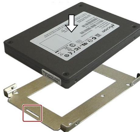
2. 新しいHDD/SSDを筐体に挿入します。銘板が上側になっていることに注意します。取り付け穴が見えるまで、HDD/SSDを筐体内にスライドさせます。
