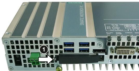
2. 図示されているようにCFastカードをスロットに挿入します。
