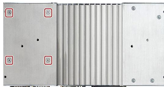
4. カバーを筐体に挿入します。マークされたネジを回し込みます。
