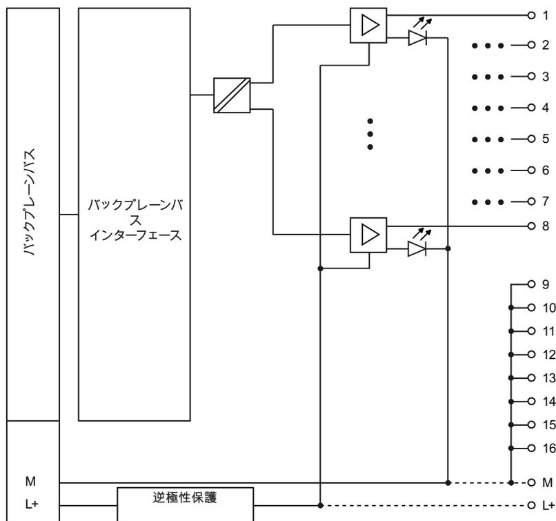
図 3-1 DQ 8x24VDC/0,5A ST の回路概略図
