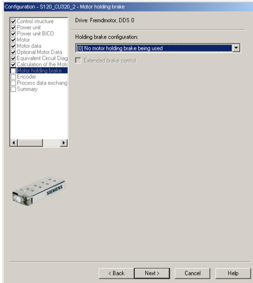
図 3-48 モータ保持ブレーキをコンフィグレーションするための画面
