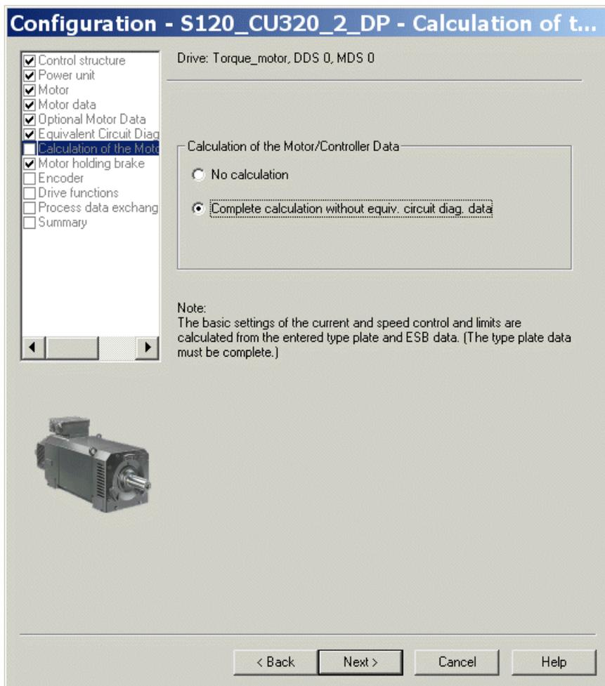
図 3-76 モータ/コントローラデータの計算用画面
