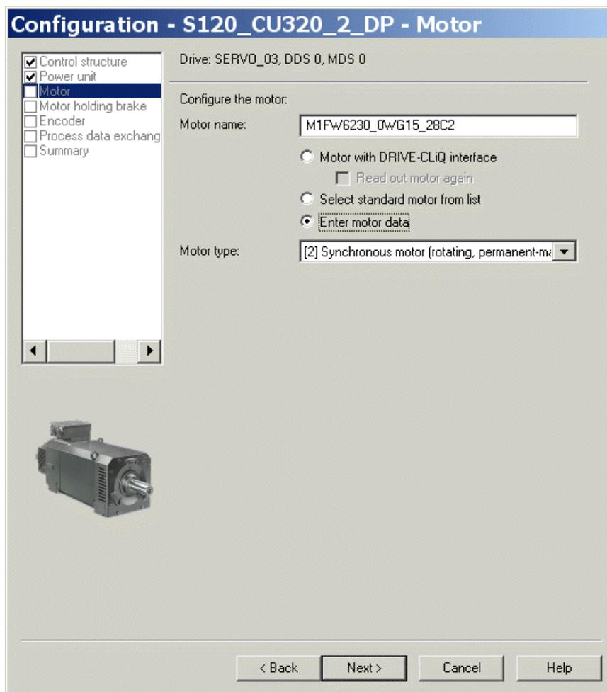
図 3-72 モータのコンフィグレーション画面 - 他社製モータの設定
