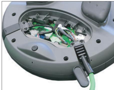
5.6 本の PT ネジを締め付けて、カバーを取り付けます。
