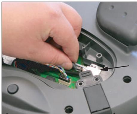
4. RJ-45 コネクタを Ethernet ソケットに接続します。
