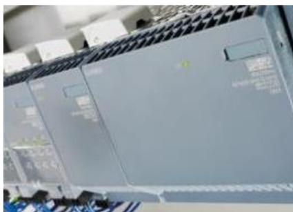
バッファモジュールやUPSモジュールを使用することで、数秒の瞬停から長時間に及ぶ停電までから機器を保護します。
