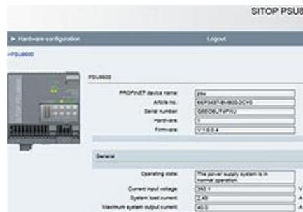
保全PCIに専用ソフトをインストールしたくない場合でも、PSU8600ならWebサーバーを内蔵しているため、標準のWebブラウザで簡単な設定とモニタリングが可能です。
