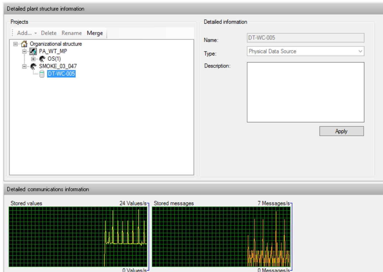
基本エリアに拡張構造を追加することができます。構造ツリーのエントリを編集し、必要に応じてその深さを拡張できます。
