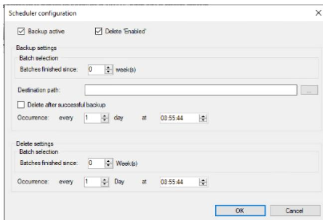
2. スケジューラが自動的にバッチを保存するように、[バックアップ有効]チェックボックスを選択します。
