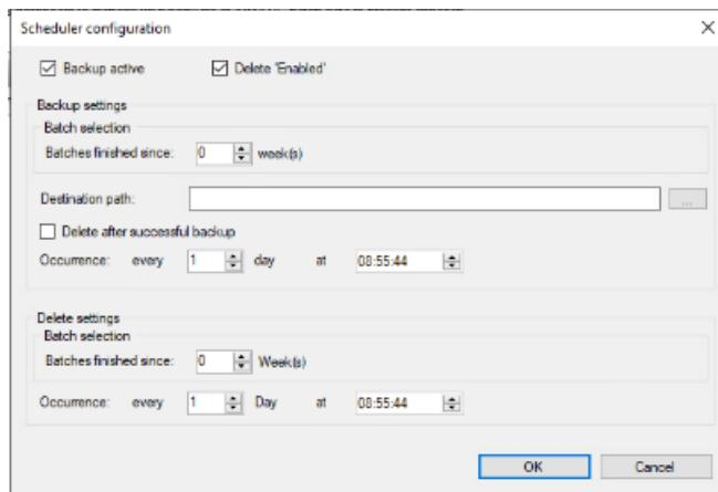
2. [削除有効]チェックボックスを選択すると、スケジューラが自動的にアーカイブ済みデータを削除します。
