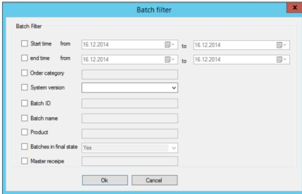
2. バッチデータをフィルタ処理したい条件を有効にします。
