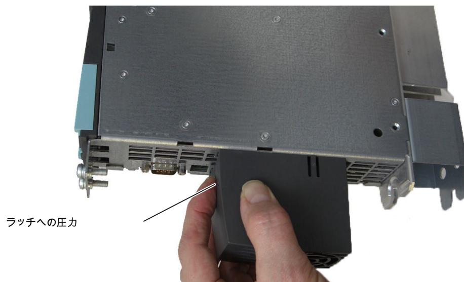
図 7-3 ダブルファン/バッテリーモジュールの取り外し
