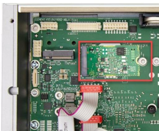
2 マザーボードの M.2 モジュールでゴールドフィンガーを揃えてから、スロットに完全にはまるまで M.2 モジュールを押し込みます。
