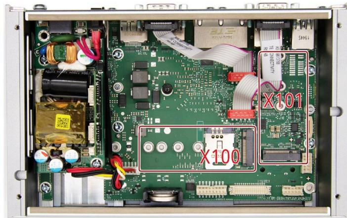
Siemens IPC はハウジングに標準化された開口部を提供し、装置を追加の外部インターフェースで拡張できるようにしています。
