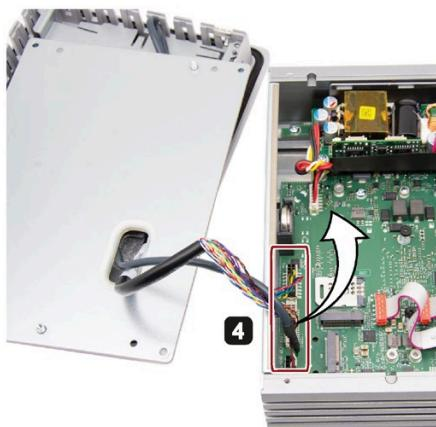
④ マザーボードの印付けされた 3 つのケーブルを取り外します。
