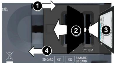
3. 新しいメモリカードを挿入して、音がして所定の位置に確実にはまり込むようにします。
