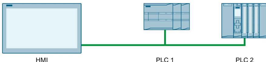
次に、HMI デバイスを使用してプロセスを操作および監視します。
