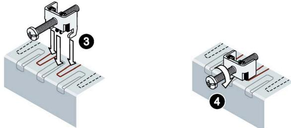
4. 取り付けクリップを固定するには、スクリュードライバを使用して止めネジを締め付けます(トルク 0.5 Nm)。
