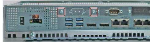
6. 内側から追加のインターフェースカードを使用されていない筐体開口部に配置し、ネジを使用してこれを固定します。
