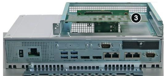
4. クランプを再挿入し、図示されている方向にクランプをスライドさせます。
