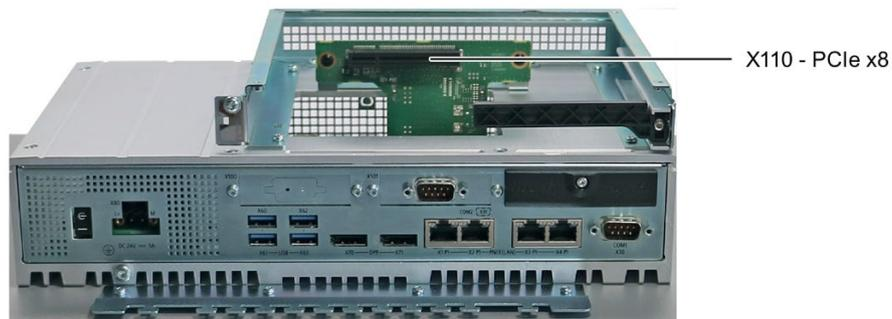
図 6-1 1つの PCIe スロットの装置バージョン
