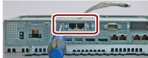
7. インターフェースカードのケーブルを M.2 モジュールに接続します。
