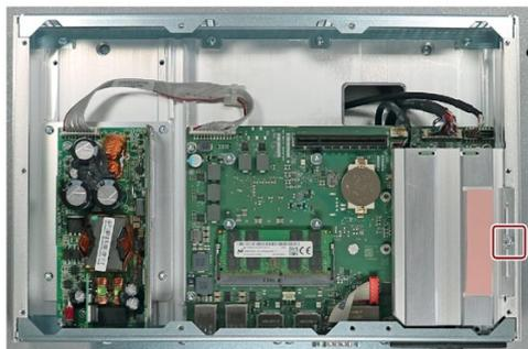
2. Torx T8 型のネジまわしを使用して、マザーボードの指定されたネジを外します。
