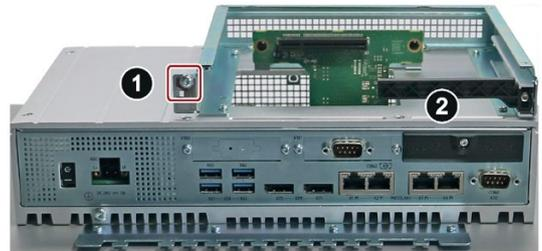
3. 拡張カードをバスボード(3)のスロットに挿入します。
