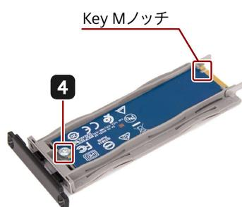
**4** スロットに M.2 NVMe/SATA SSD を配置して、指定のネジで固定します。
