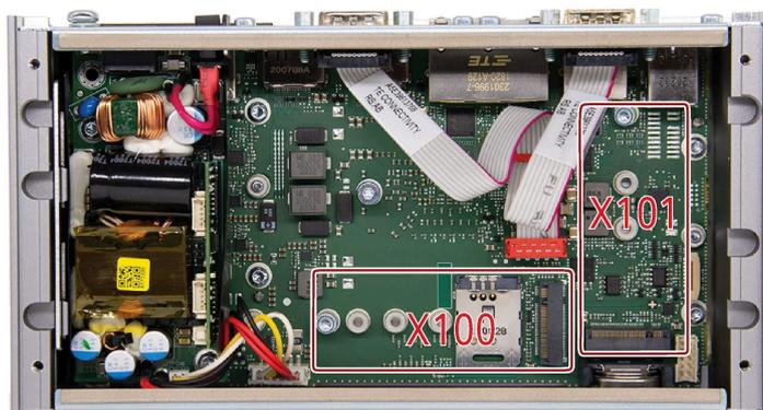
Siemens IPC はハウジングに標準化された開口部を提供し、装置を追加の外部インターフェースで拡張できるようにしています。
