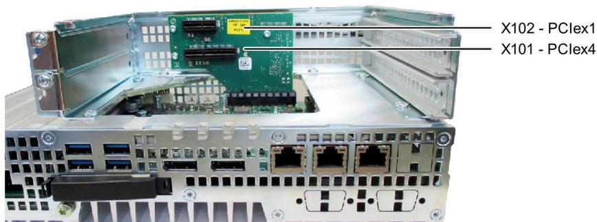
図 6-2 2 つの PCIe スロットの装置バージョン
