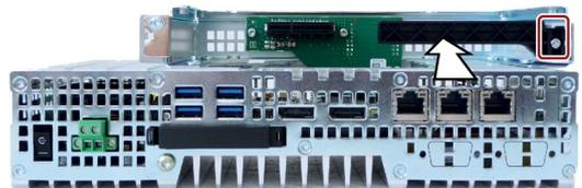
5. 「拡張カードを含む装置を開く (ページ 70)」のセクションで指定されているように装置を閉じます。
