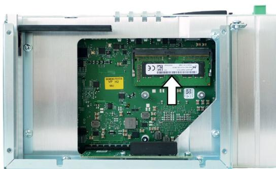
新しいメモリ設定が自動的に検出されます。メモリ構成は、メイン BIOS Setup メニューの[Total Memory]に表示されています。
