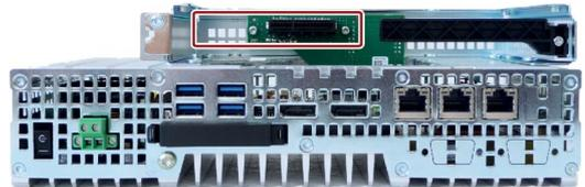
4. 図示されている方向にクランプをスライドさせます。
