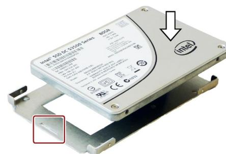
2. 新しい HDD/SSD を筐体に挿入します。銘板が上側になっていることに注意します。取り付け穴が見えるまで、HDD/SSD を筐体内にスライドさせます。
