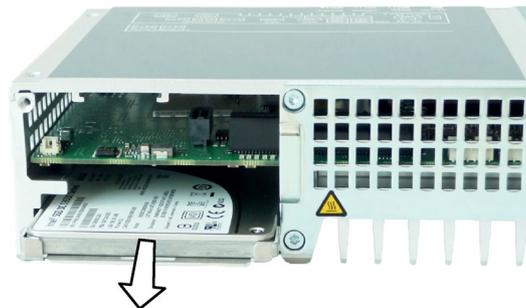
4. 図示されているように、ベースプレートの側面で HDD/SSD を緩めます。
