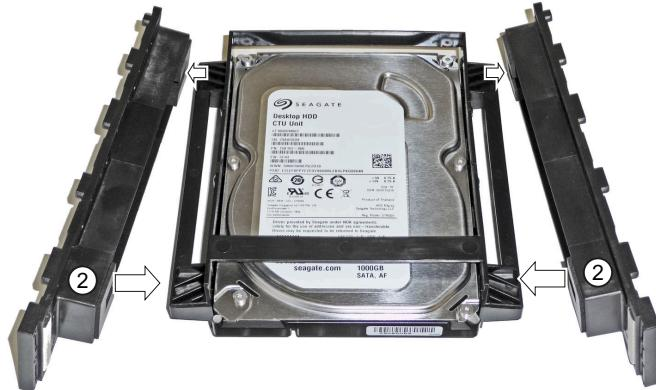
8. ドライブベイを平らにしてドライブケージのガイドレールの背面に3/4ほどスライドさせて入れます。左にも右にも傾かないようにします。
