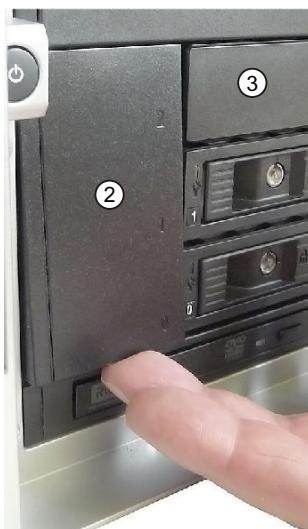
4. ドライブケージの前面にあるカバーの右側にあるブランкиングプレート③を取り外します。
