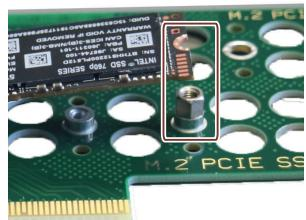
3. バスボードの対応するスロットのPCIeアダプタカードに取り付けます。
