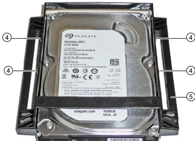
図 7-1 HDD付きドライブベイ
