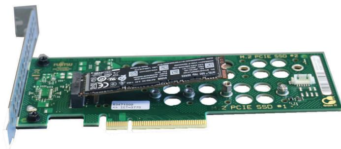
2. M.2 NVMe SSDを下方に慎重に押し込み、ネジでPCIeアダプタカードに固定します。
