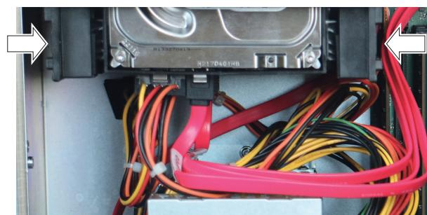
2. ドライブ取り付けバー③をブランкиングプレート②と一緒に、取り付け位置から前方に取り出します。
