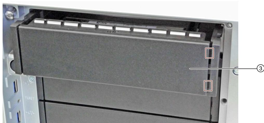
10. ドライブベイを、左右均等に、ドライブケージに音がしてかみ合うまで、完全に押し込みます。
