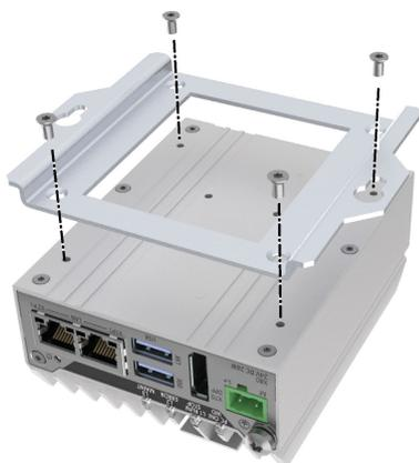
1. 取り付け面に固定用穴の印を付けます。
