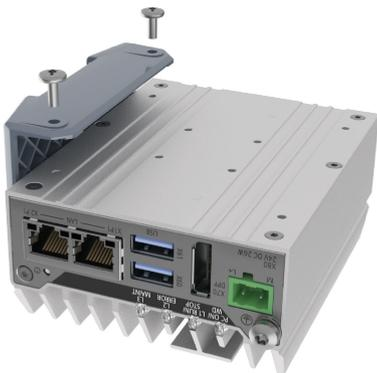
1. 取り付けブラケットを装置の背面に取り付けます。
