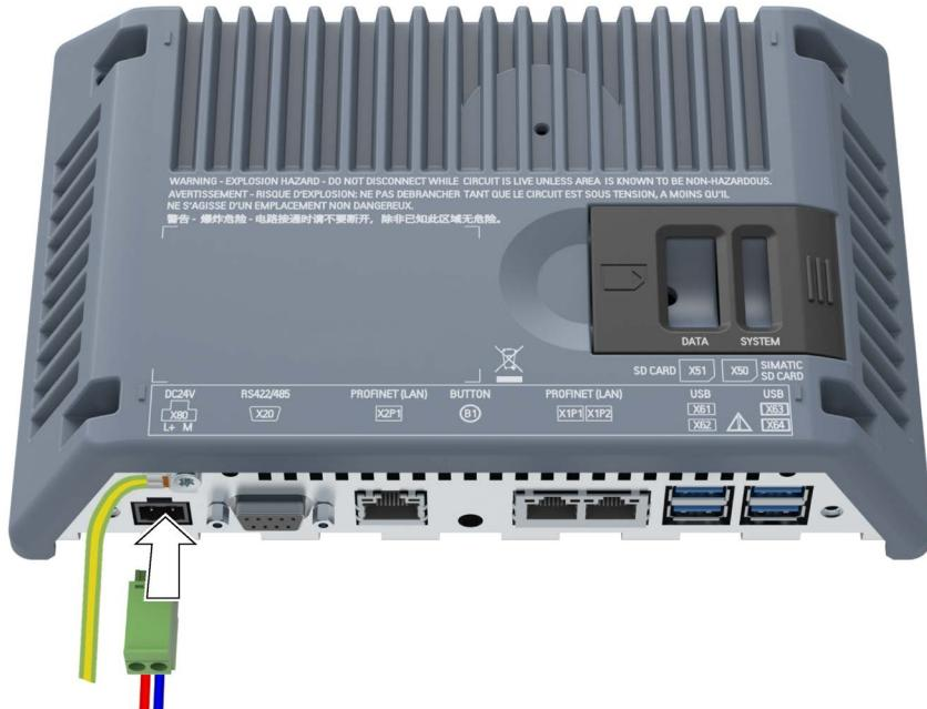
4. HMIデバイスの背面にラベル付けされているインターフェースを使用して、ケーブルの正しい極性を確認します。
