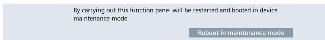
[Reboot in maintenance mode]:保守モードで再起動するためのボタン。保守モードでの再起動は、HMIデバイスを出荷時設定にリセットするために必要です。
