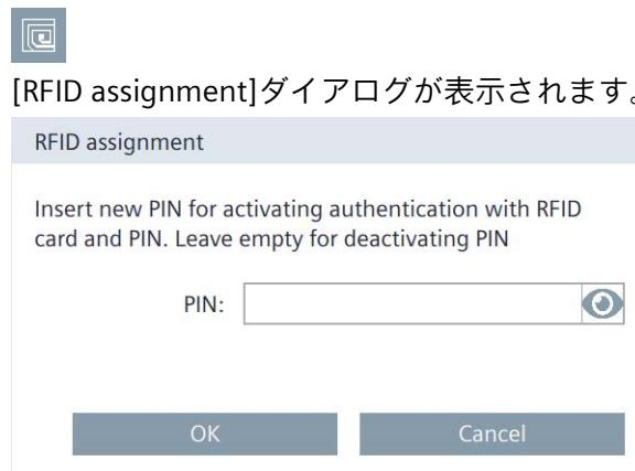
4. PINなしでRFIDログインを使用する場合は、[PIN]テキストボックスをブランクにしておきます。
