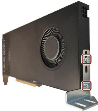
4. GPUカードを適切なスロットに挿入し、スロットカバーを締めて固定します。
