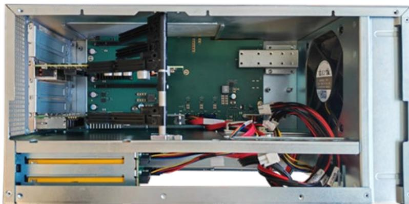
4. 拡張カードとスロットカバーを、「スロットカバーとスロットブラケットの取り外し (ページ 196)」セクションの手順2から4を逆の順序で実行して固定します。
