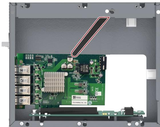
3. PCIeカードとスロットカバーを、「スロットカバーとスロットブラケットの取り外し (ページ 148)」セクションの手順2から4を逆の順序で実行して固定します。
