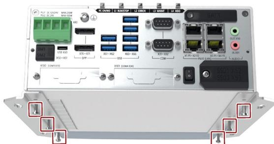
3. 取り付けブラケットのある装置を取り付け表面に配置します。
