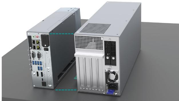
5. T10スクリュードライバをマークの付いた穴に差し込み、4スロット/6スロットEMとBMを3本の脱落防止ネジで固定します。
