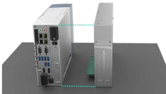
5. T10スクリュードライバをマークの付いた穴に差し込み、2スロットEMとBMを3本の脱落防止ネジで固定します。
