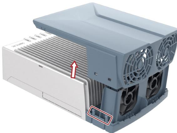
3. ファンケーブルコネクタを外してファンを引き出し、新しいファンと交換し、ファンケーブルをコネクタに再接続して、新しいファンをファンスロットに挿入し直します。
