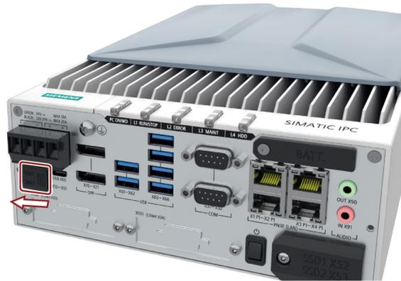
2. nanoSIMカードを支持フレームに正しく挿入します。
