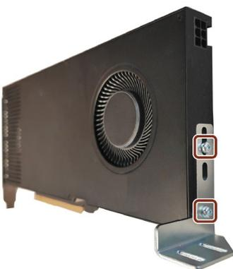
5. GPUカードを適切なスロットに挿入し、スロットカバーを締めて固定します。
