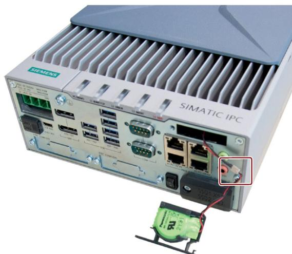
3. わずかな圧力を加えながら、新しいバッテリーをソケットに押し込みます。
