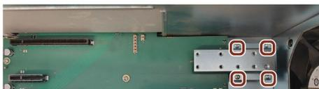
2. GPUカードを適切なスロットに挿入し、スロットカバーを締めて固定します。
