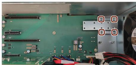
3. マークの付いた2本のネジを使用して、GPUブラケットをGPUカードの背面に固定します。
