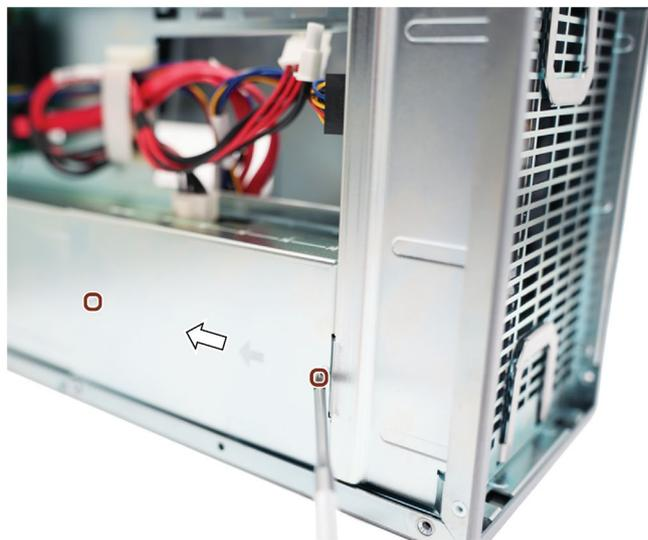
2. アダプターボードのカバーにあるソケットカバーを取り外します。
