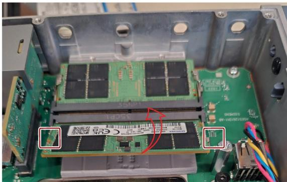
4. わずかに圧力を加えながら、サーマルパッドを下向きにして新しいモジュールを挿入し、ロックがカチッと所定の位置にはまるまで押します。
