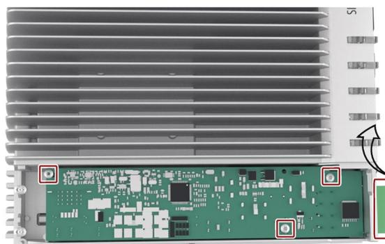
3. DC電源を取り外し、別のDC電源と交換します。
