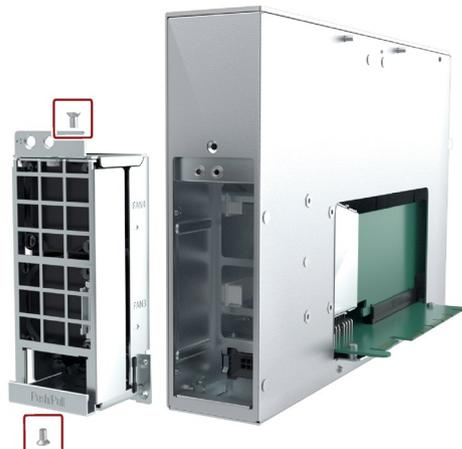
4. T10スクレュードライバを使用して、ファンの4つの黒いスナップリベットの両端を押して、クリップから外します。
