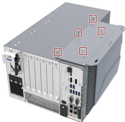
2. 次の取り付けブラケットを2スロットEMの背面に配置し、ブラケットを3本のM3ネジで固定します。
