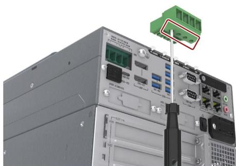
6. ケーブル接続された端子台をBM電源コネクタに差し込みます。
