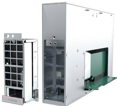
3. マークの付いた2本のネジとフィルタパッドサポート部分を取り外します。
