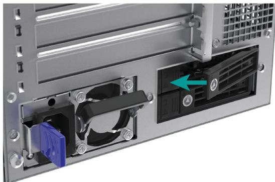
3. 取り外し可能なトレイの側面にある強調表示されているネジを緩め、ドライブを取り外します。
