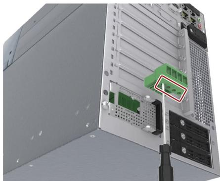
3. ケーブル接続された端子台をEM電源コネクタに差し込みます。
