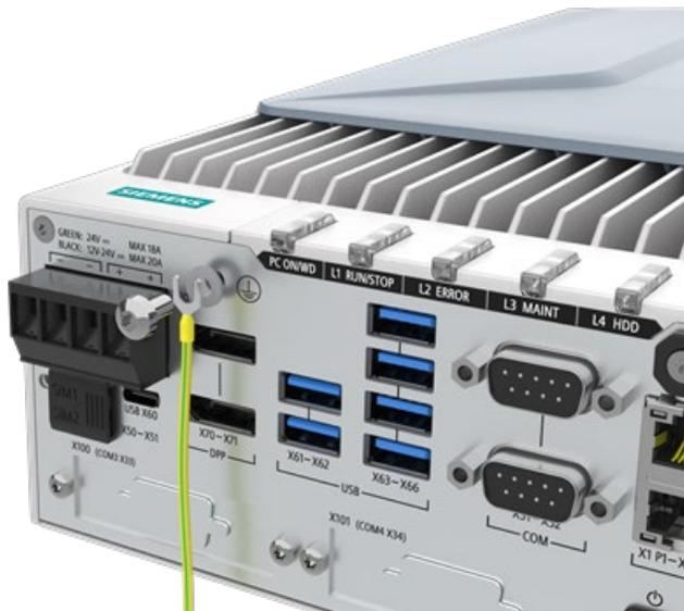
3. 保護導体を、装置が設置されているキャビネットまたはプラントの保護導体接続部に接続します。
