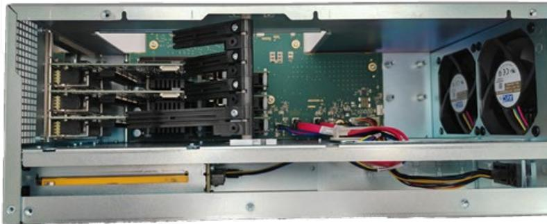
4. 拡張カードとスロットカバーを、「スロットカバーとスロットブラケットの取り外し (ページ 180)」セクションの手順2から4を逆の順序で実行して固定します。
