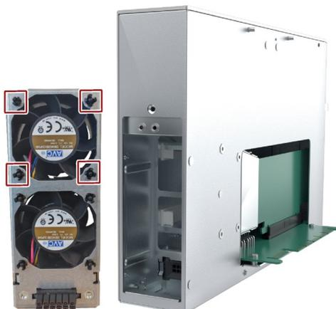
5. 筐体の4つのプラスチックリベットを取り外し、ファンプラグを引き抜きます。
