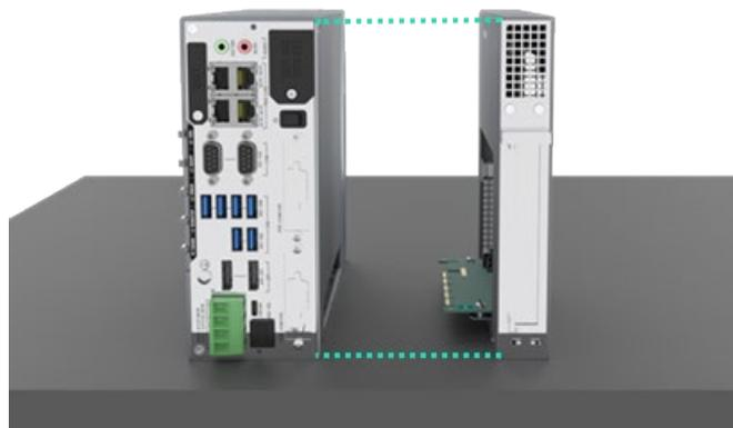
5. T10スクリュードライバをマークの付いた穴に差し込み、1スロットEMとBMを3本の脱落防止ネジで固定します。
