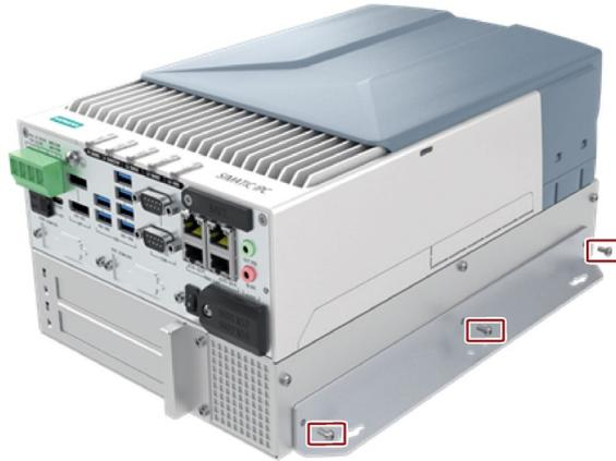
2. 装置を取り付け壁または取り付けデスクに置きます。
